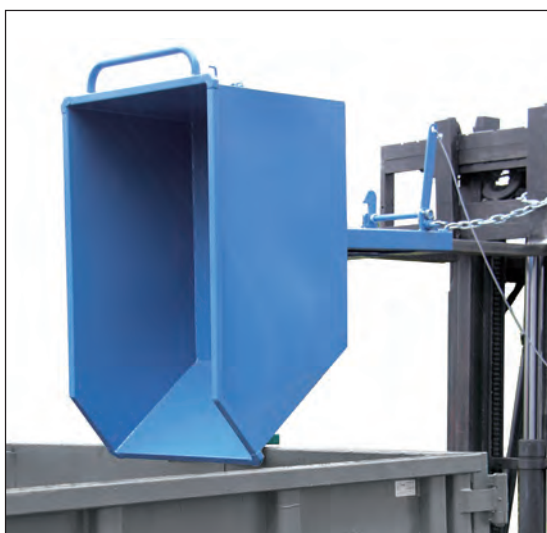
Benne comme collecteur de déchets avec chariot élévateur.
